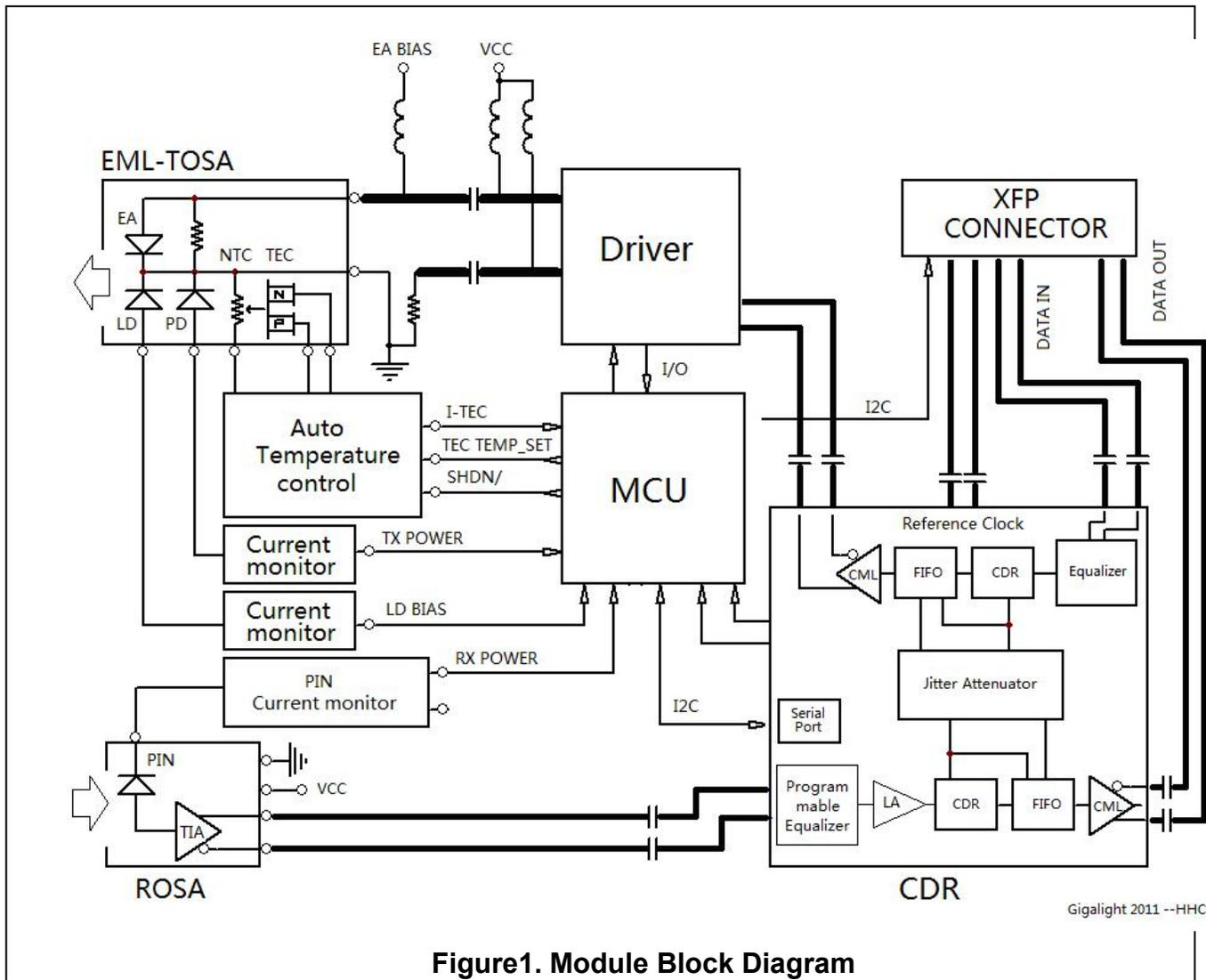
Figure1. Module Block Diagram
