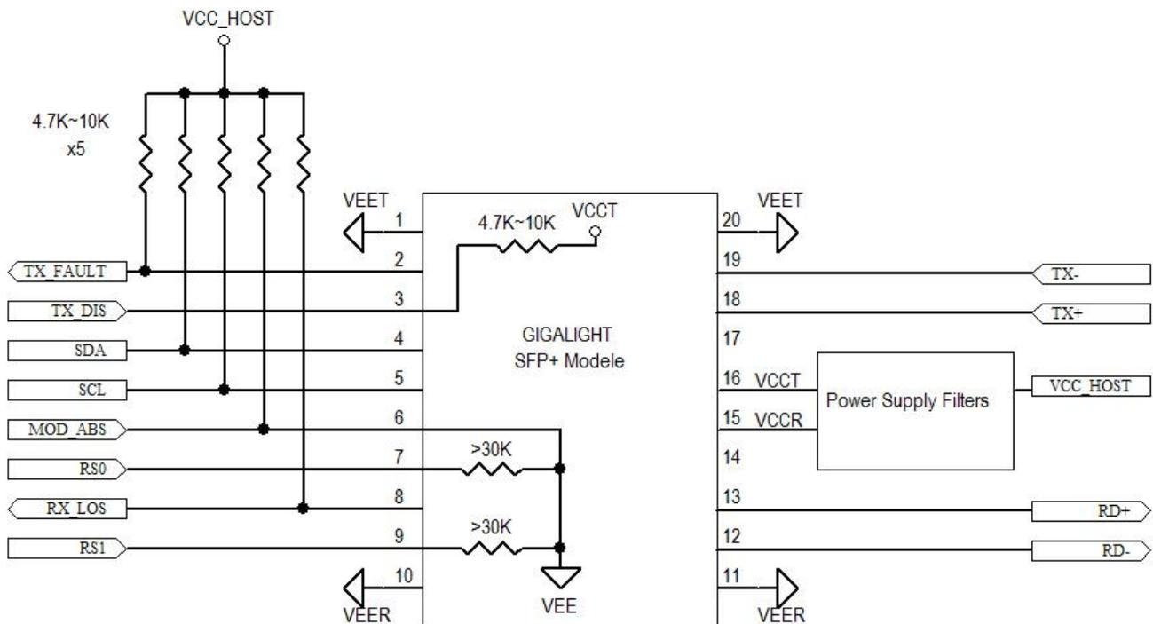
Figure4. Host-Module Interface
