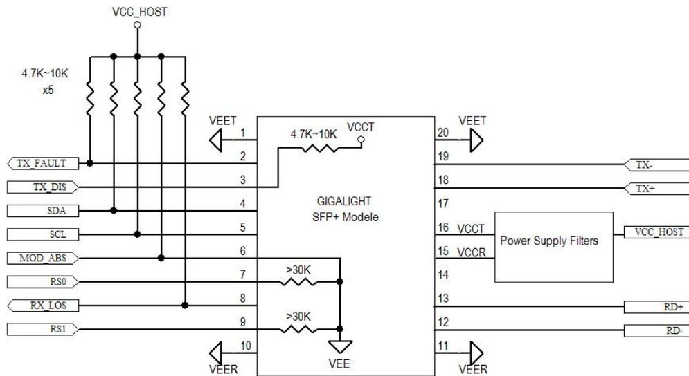
Figure4. Host-Module Interface
